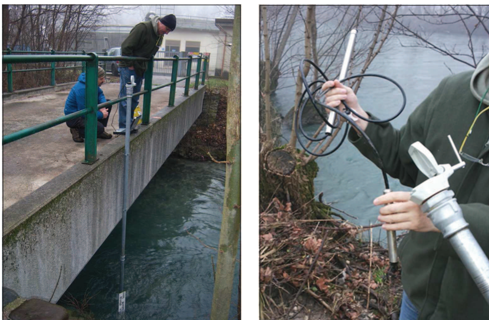
Figura 5.8: Immagine relativa alla Sezione 10 (a sinistra) e sonda idrometrica e tubo d'alloggiamento (a destra).
