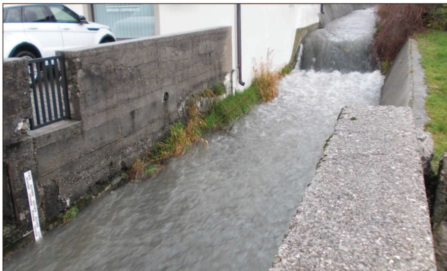
Figura 5.18: Asta idrometrica posizionata presso la Sezione 11 (Roggia di Gemona).
