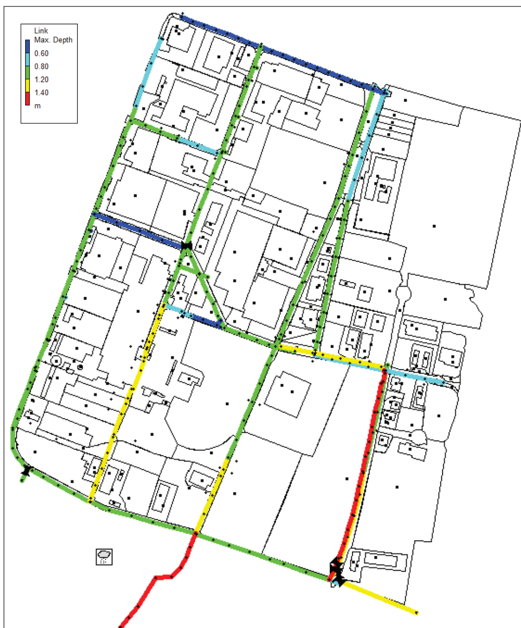
Figura 7.11: Schematizzazione della rete di drenaggio dell'area industriale CIPAF modellata per mezzo del software EPA-SWMM e rappresentazione delle dimensioni dei collettori.
