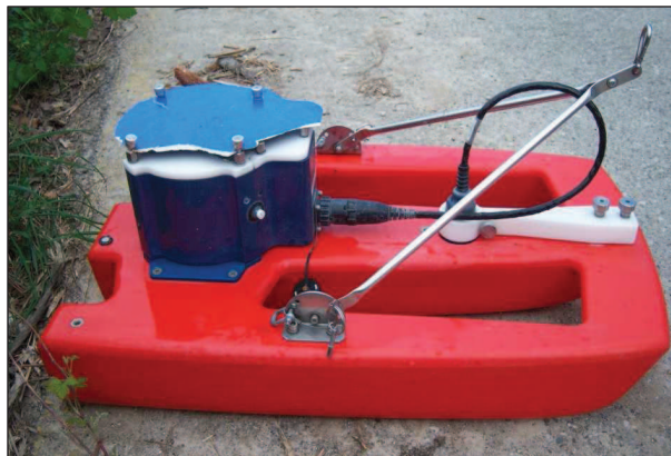
Figura 5.5: Profilatore di velocità ADCP installato su natante.
