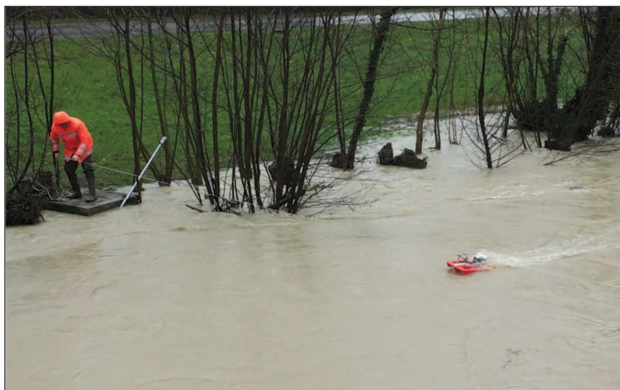
Figura 5.12: Misura di portata presso la Sezione 4 effettuata in data 17/02/2014.
