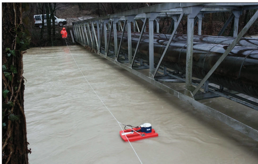
Figura 5.11: Misura di portata presso la Sezione 5 effettuata in data 17/02/2014.
