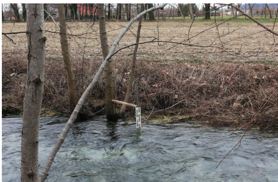
Figura 5.16: Asta idrometrica posizionata presso la Sezione 9 (Roggia Bianca).
