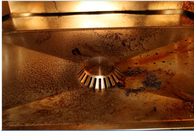
Figura 9.3: Residui presenti all'interno della cavità del forno GC in seguito ad una cottura di carne grigliata.
