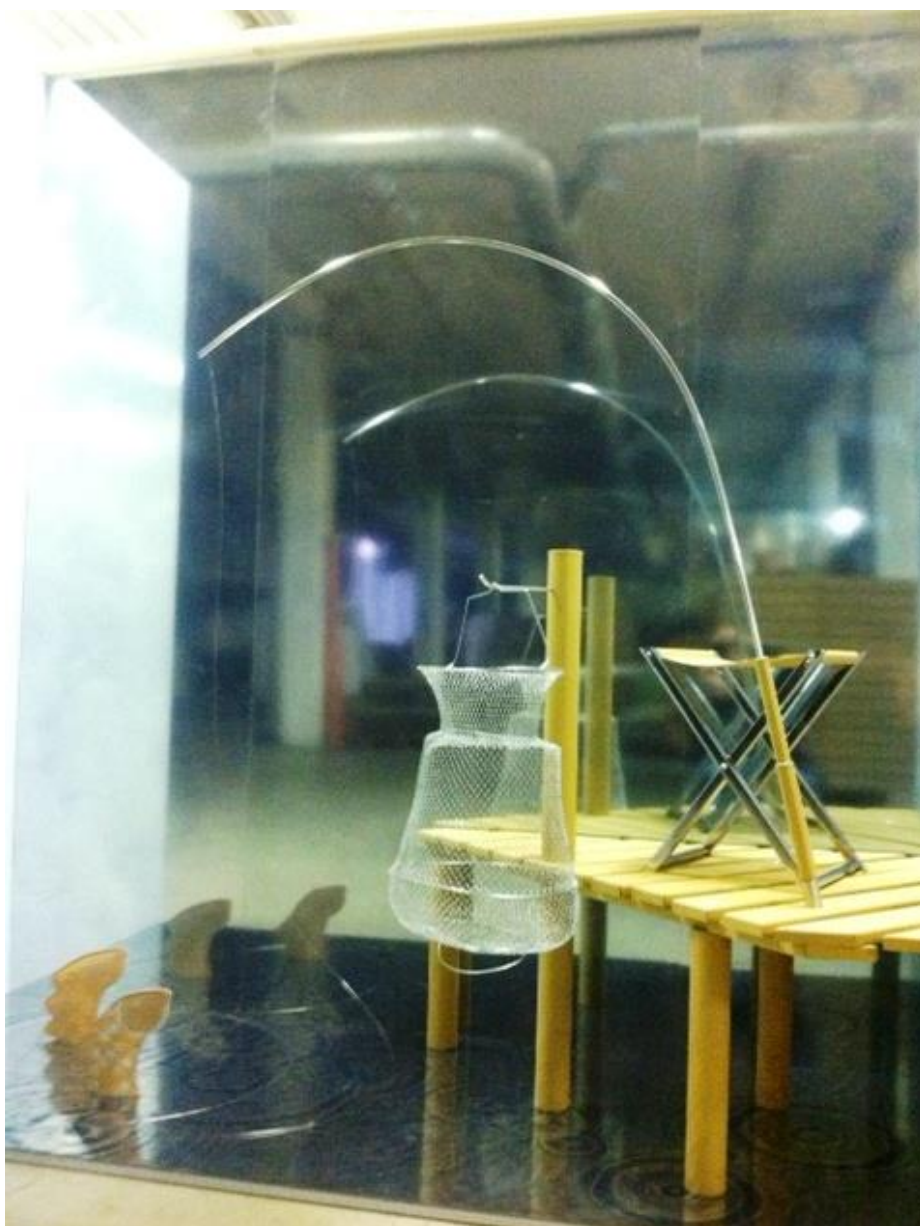
Fig. 66 – CQS per Tod's, prototipo iniziale della vetrina pesca da realizzare, installato nel box ricreato su misura dall'azienda produttrice per verificare le misure finali e la resa ottica in base allo spazio effettivo.
