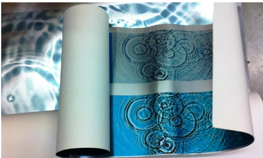
Fig. 68 – CQS per Tod's, alcune prove di stampa con diverse tecniche e supporti grafici per selezionare il tipo di effetto da produrre
