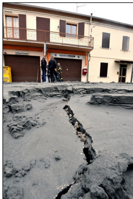
Fig. 5.16: Fessurazioni del terreno con espulsioni di sabbia in località San Carlo (FE) a seguito dell'evento sismico del 2012 in Emilia.
