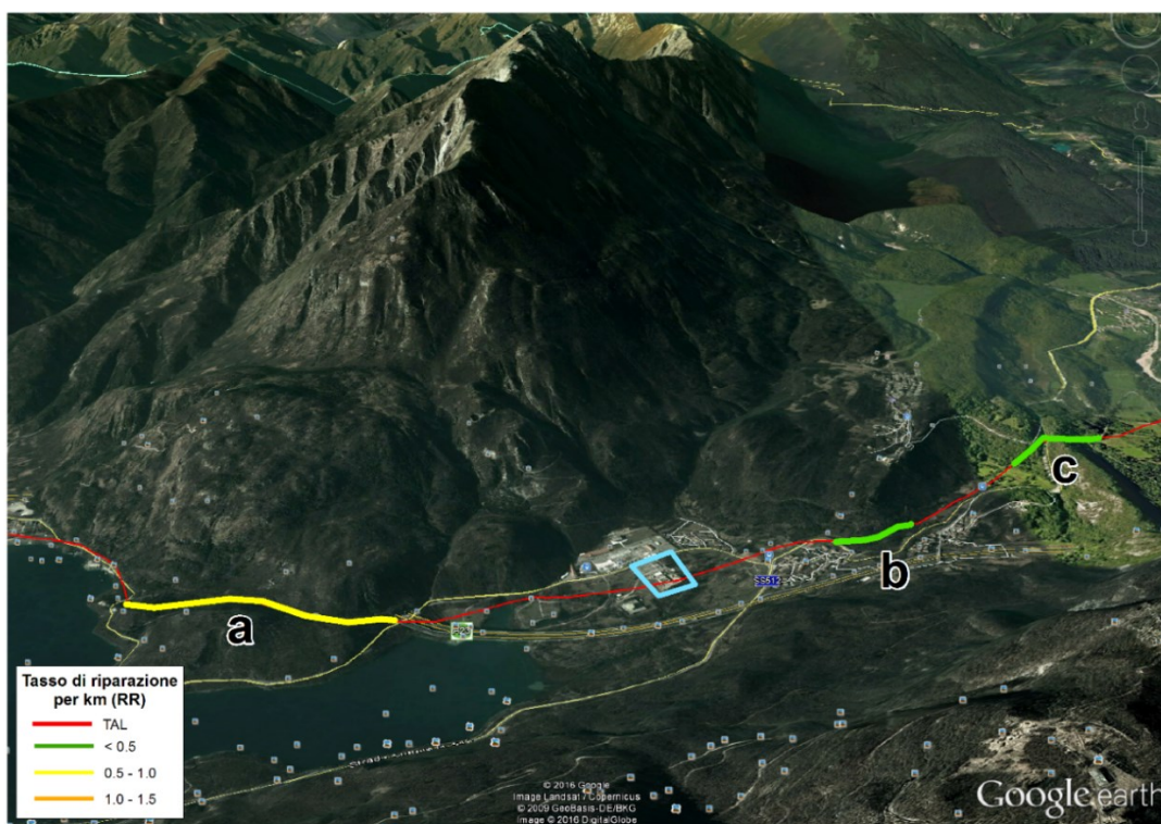
Fig. 7.6: Visualizzazione tridimensionale (Google Earth™) della zona 1 di Fig. 7.5, in cui sono localizzati i tratti di tubazione (a, b, c) che potrebbero subire danneggiamento e classificati sulla base del tasso di riparazione ottenuto. Il rettangolo celeste identifica la stazione di pompaggio.
