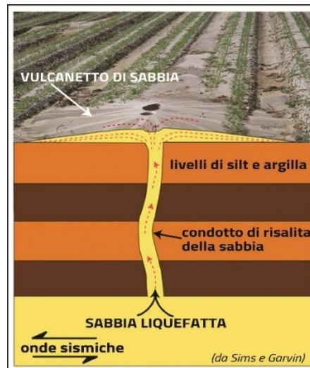
Fig. 5.20: Schema di formazione di un vulcanetto di sabbia ( sand boil ) a seguito di un evento sismico (Sims and Garvin 1995 modificato da INGV).
