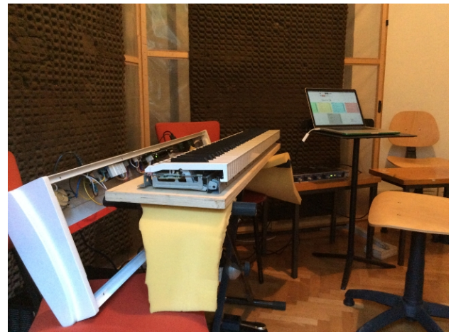
Figura 5. La strumentazione utilizzata per la valutazione qualitativa di un piano digitale con feedback vibrotattile.
