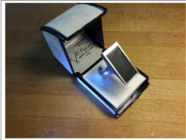
Figura 6. Mockup dell'anello elettroacustico: lo speaker diventa elemento qualificante dell'estetica.
