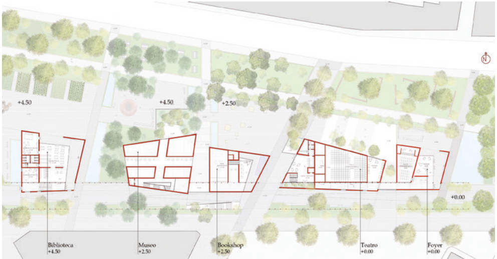
Fig.02 La soluzione planimetrica propone una sequenza di volumi innestati su un percorso longitudinale, asse strutturante del sistema e di riferimento per l'orientamento.
