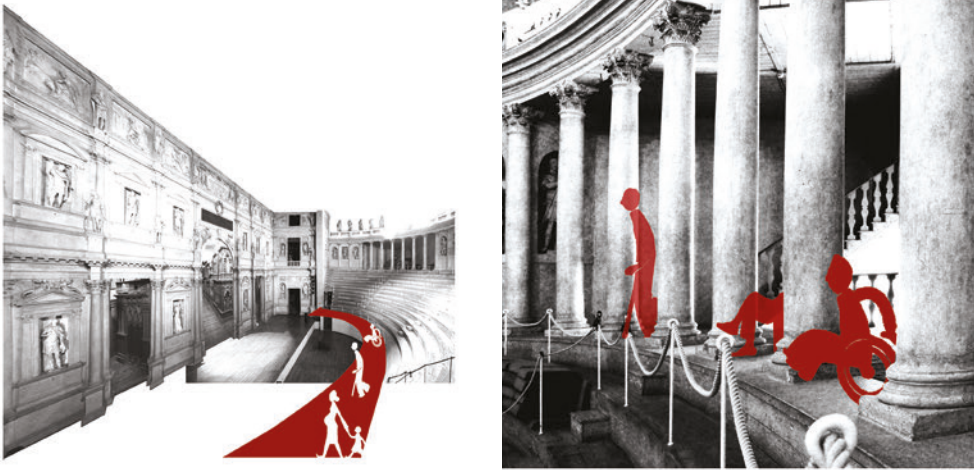
Fig.03 A sinistra il nuovo ballatoio mobile, progetto. Il dispositivo tecnologico è utilizzabile solo in occasione degli spettacoli ed è rivolto a risolvere la questione sulla sicurezza del teatro e a migliorare la logica di collocazione delle persone con disabilità. A destra, loggia accessibile, progetto. L'inserimento di una piattaforma elevatrice in uno dei due vani scala permette a tutti gli utenti di raggiungere la sommità della cavea agevolmente.
