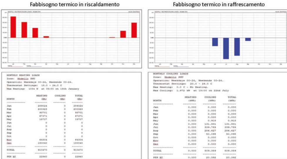
Fig.05 Risultati della simulazione energetica globale. Diagrammi e valori dei fabbisogni mensili in riscaldamento (rosso) e in raffreddamento (blu).
