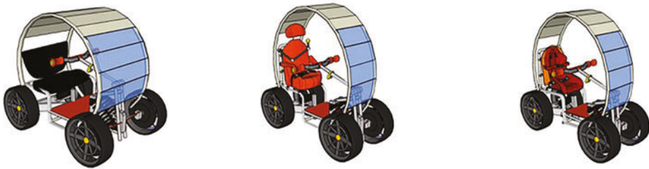
Fig.02 Prototipo Roty, esempio con seduta singola con carrozzeria, esempio completo con seduta doppia, con sistema posturale per adulti e con sistema posturale per bambini.
