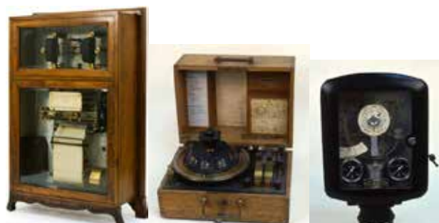
Fig. 4. (da sinistra) Wattmetro C.G.S. - Società Anonima per Istrumenti elettrici, 1902, Ponte di misura Hartmann & Braun AG, 1927; Regolatore pneumatico proporzionale-integrativo-derivativo (PID) Ing.i Biondi e Terenghi, 1950.
