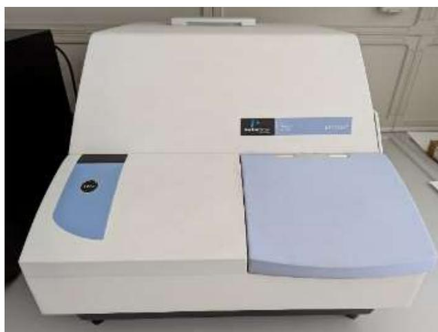
Figura 5.7: lettore di micropiastre Perkin Elmer Victor 3.
