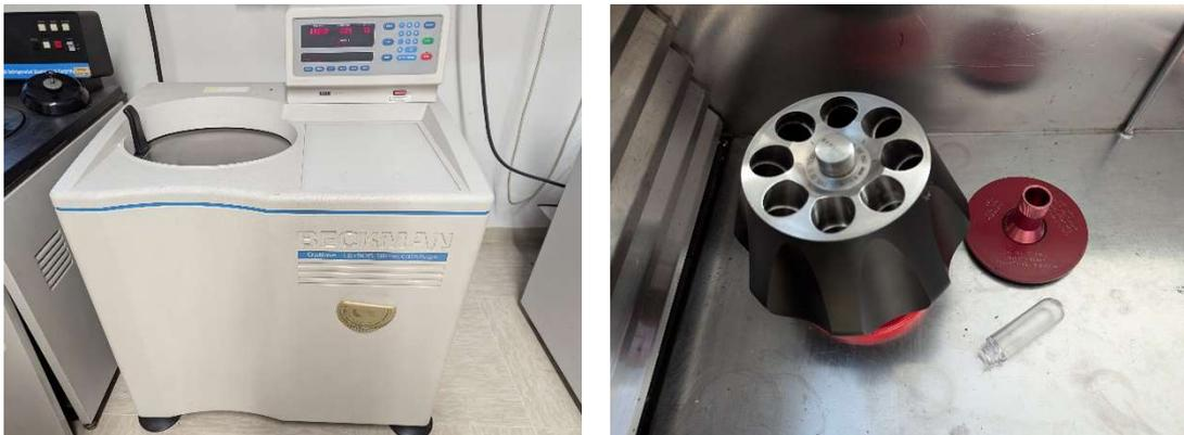
Figura 5.4: ultracentrifuga Beckman Optima LE-80k e rotore ad angolo fisso Beckman TYPE 70 Ti.
