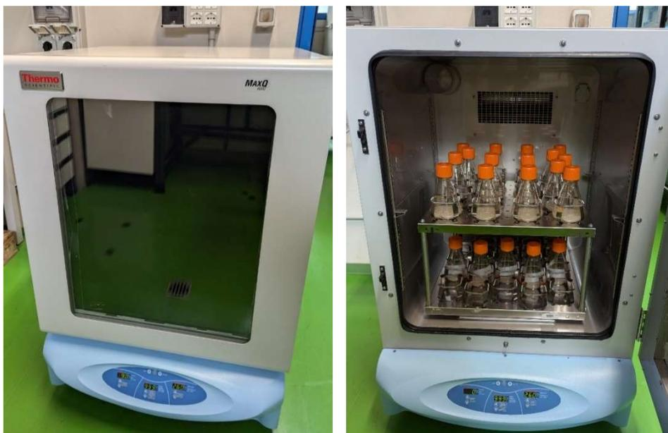
Figura 5.1: incubatore-agitatore orbitale Thermo Fisher Scientific MaxQ6000 e beute Corning con sospensioni cellulari.
