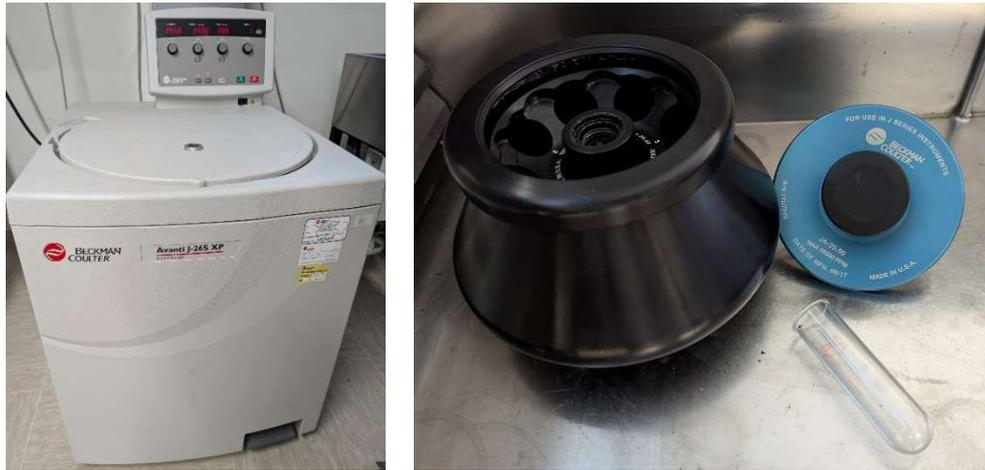
Figura 5.3: centrifuga Beckman Coulter Avanti J-26S XP e rotore Beckman Coulter JA-25.50.
