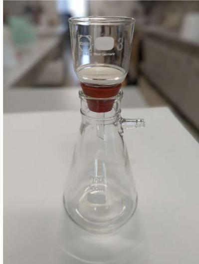
Figura 5.2: sistema di filtraggio.
