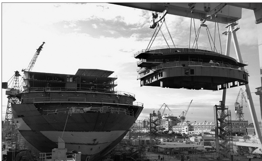
Figura 11.5 – Montaggio di una sezione di nave nella fase «di bacino»
