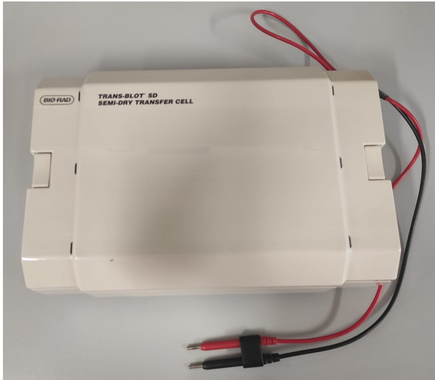
Figura 16: Cella di trasferimento Bio-Rad Trans-Blot SD Semi-Dry Transfer Cell
