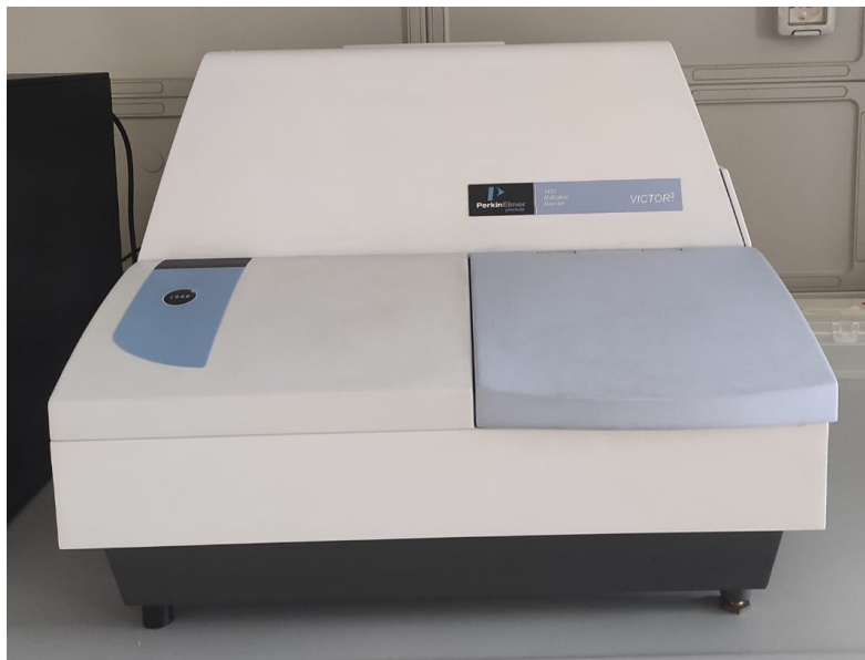
Figura 13: Lettore di micropiastre Perkin Elmer Victor 3
