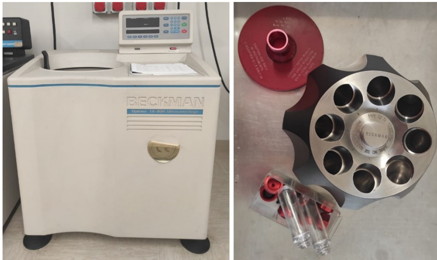
Figura 11: Ultracentrifuga Beckman Optima LE-80k e rotore ad angolo fisso Beckman TYPE 70 Ti
