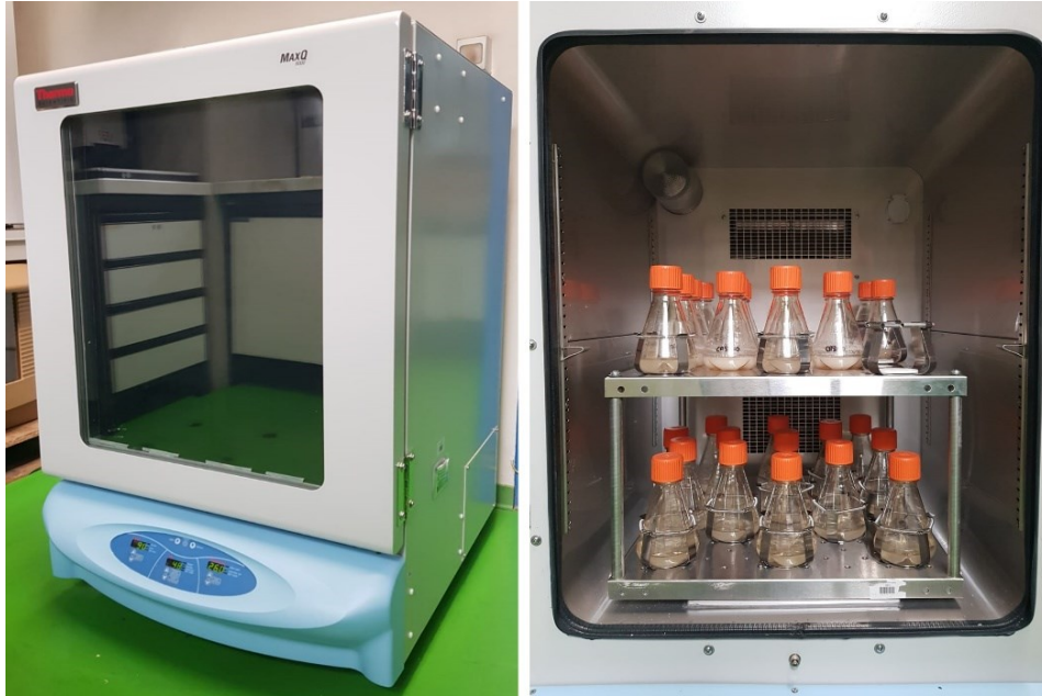
Figura 7: Agitatore rotante MaxQ6000, Thermo Fisher contenente le sospensioni cellulari.
