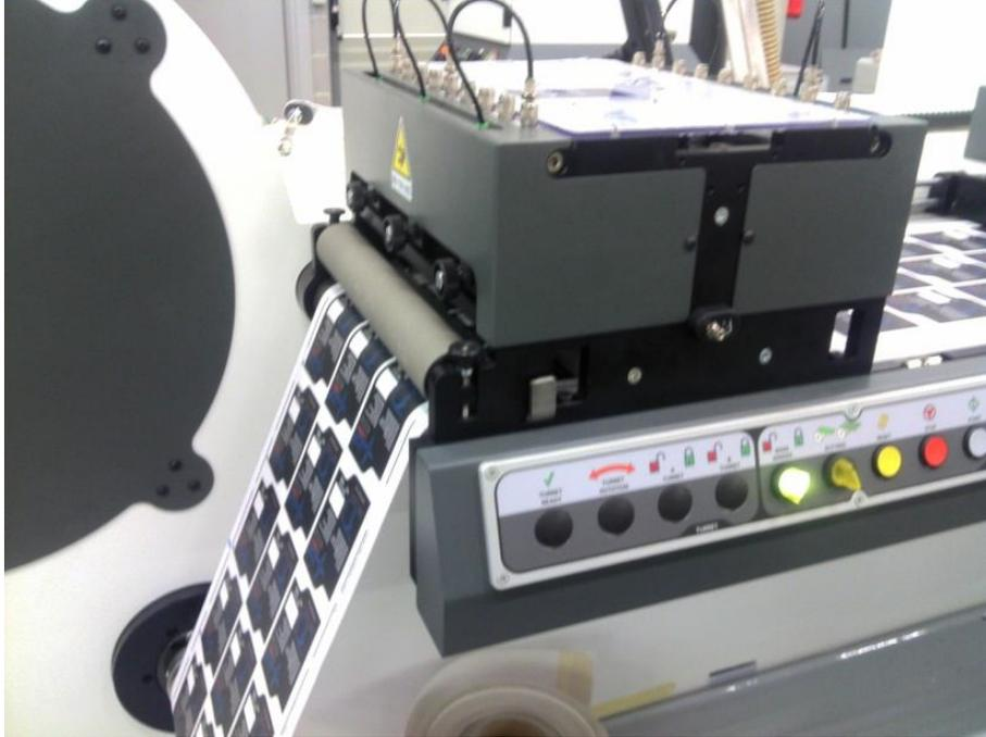
*Figura 6.8. Modulo di imballaggio delle etichette finite*
