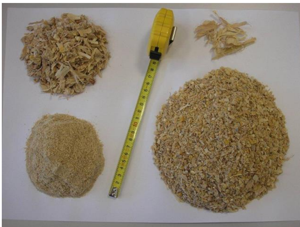
Foto 2. Ripartizione del pastone integrale di spiga di mais in 4 frazioni granulometriche utilizzando un setaccio a quattro strati (Penn State University®)
