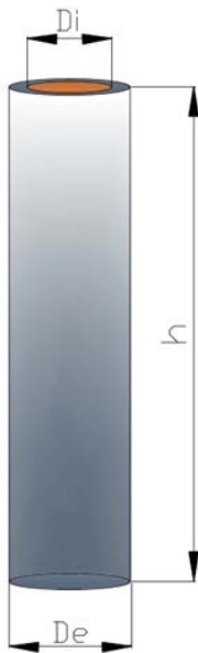
Figura 95 - Tubo contenente materiale PCM.
