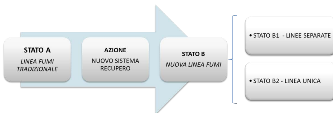
Figura 133 - Flusso logico dell'inserimento del nuovo sistema di recupero e possibili configurazioni della nuova linea fumi dell'acciaiera.
