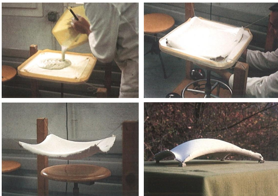
Figura 1.5 Heinz Isler, metodo della membrana inversa.
