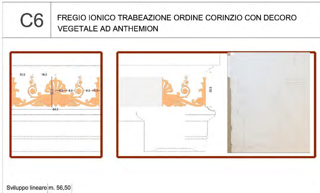
Figura 79: Disegno di ricostruzione filologica del fregio della sala teatro di Rimini. (A.C.R.)
