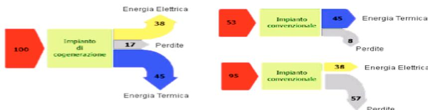
Figura 5-9: Esempio schematico tra uso tradizionale e uso attraverso la cogenerazione (Fonte : <http://www.2bs->
