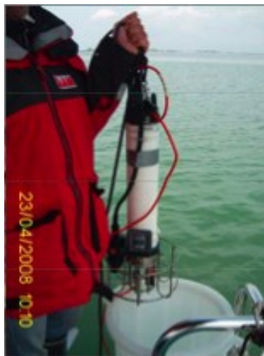
Figura 19: sonda multiparametrica idronaut Ocean Seven mod.316 .
