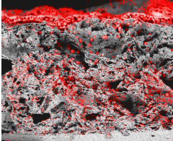
Fig.4.46: Micrografia SEM di una cella dopo test in condizioni operative (973K in H_2 umid. al 3% H_2O )
