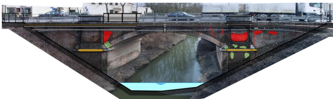
Fig. 4.12. Mappatura del degrado. Prospetto nord del ponte
