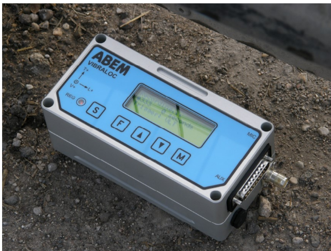
Fig. 4.17. Monitor di vibrazioni ABEM Vibraloc (L parallelo all'asse del ponte)
