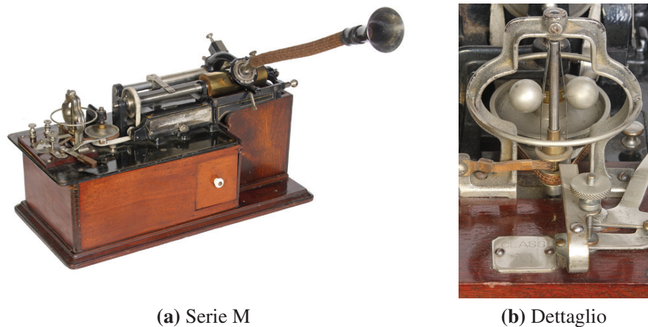
Fig. 1.1.6: Fonografo di Edison della serie M con un dettaglio delle sfere che controllano il movimento di rotazione del cilindro.
