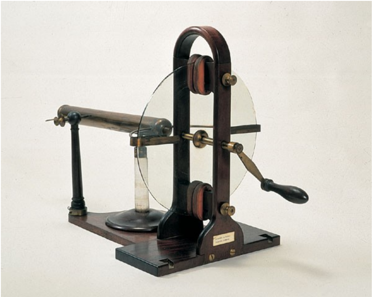
Doc. H Collezione Bardi, Jesse Ramsden Macchina elettrostatica , Fondazione scienza e tecnica, Firenze
