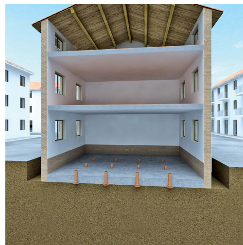
Fig. 6. 46 – Fasi esecutive schematiche presentate dalla Consta S.p.A, edificio preesistente e realizzazione della prima platea non collegata al fabbricato
