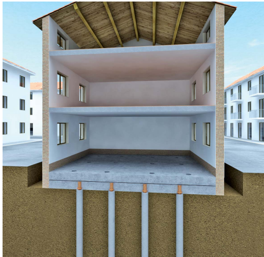
Fig. 6. 47 - Fasi esecutive schematiche presentate dalla Consta S.p.A, esecuzione dei pali Soles (se necessari) e realizzazione della seconda platea collegata al fabbricato
