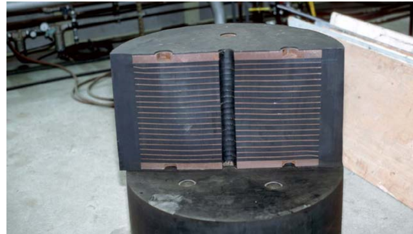
Fig. 2.38 – Isolatore sismico elastomerico fibro-rinforzato di ultima generazione, archivio prof. James M. Kelly.
