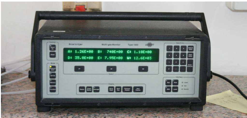
Figura 121: particolare dell' analizzatore foto-acustico Bruel&Kjaer 1302 utilizzato per la determinazione delle emissioni.
