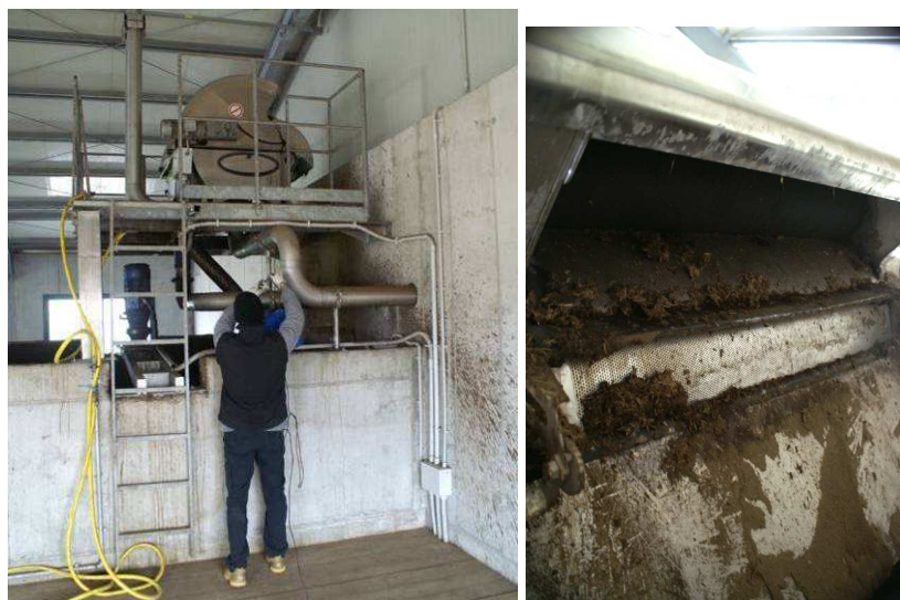
Figura 32: particolari del separatore a rulli installato nell'impianto.
