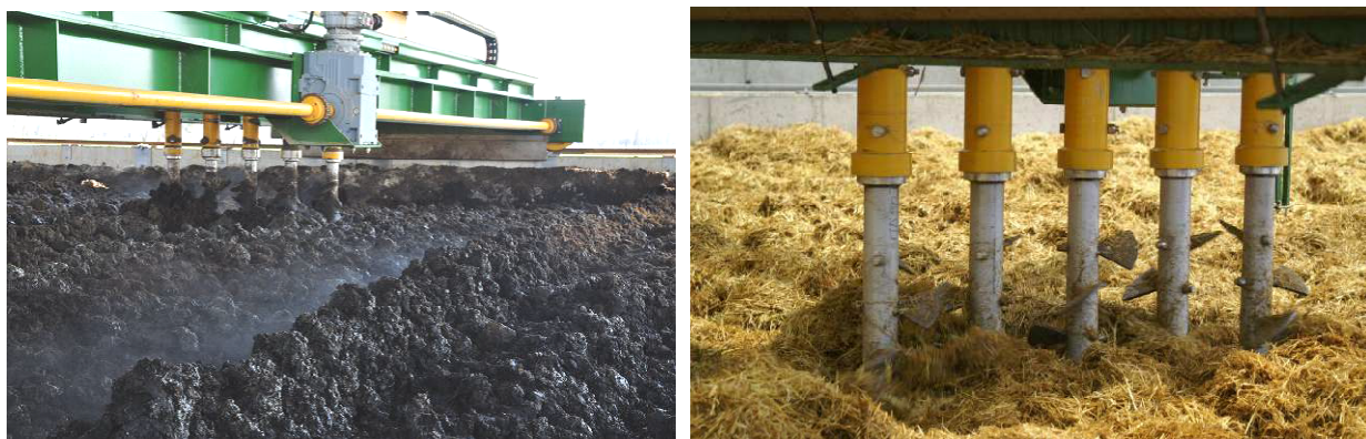
Figura 83: fase di rimescolamento – ossigenazione cocleare in impianti con substrato in truciolo di legno (sinistra) e paglia (destra). (foto: Chiumenti A.)
