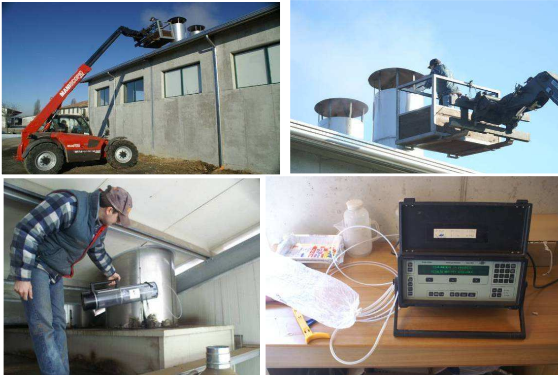
Figura 129: particolari dei campionamenti per la determinazione delle emissioni dall'essiccazione: si sono effettuati campionamenti con apposito aspiratore e sacchi di Nalophan e/o misure dirette con analizzatore Bruel & Kjaer .
