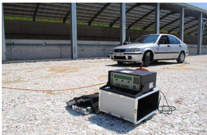
Figura 86: primo piano del multi-gas monitor in fase di monitoraggio ambientale.
