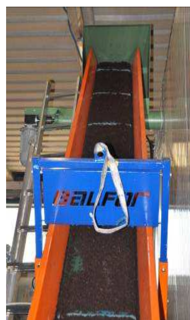
Figura 134: a sinistra l'impianto pilota in scala reale realizzato, a destra un dettaglio del nastro di carico.
