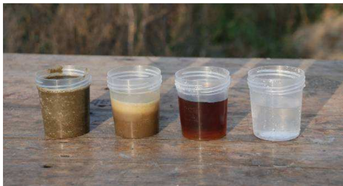
Figura 62: particolare degli output liquidi delle diverse fasi di trattamento, rispettivamente, da sinistra: effluente dal separatore, chiarificato centrifuga, permeato ultra-filtrazione, permeato osmosi.
