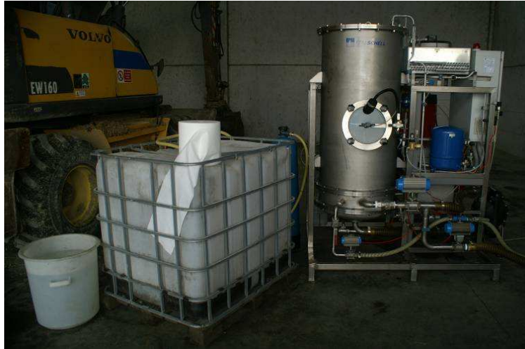
Figura 20: impianto pilota di evaporazione sotto vuoto (fonte: Chiumenti)
