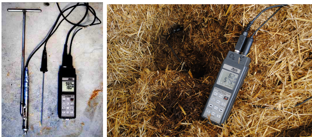
Figura 90: ossimetro, sonda di temperatura, puntale e data logger: strumenti utilizzati per monitorare la percentuale di ossigeno interstiziale nella biomassa.
