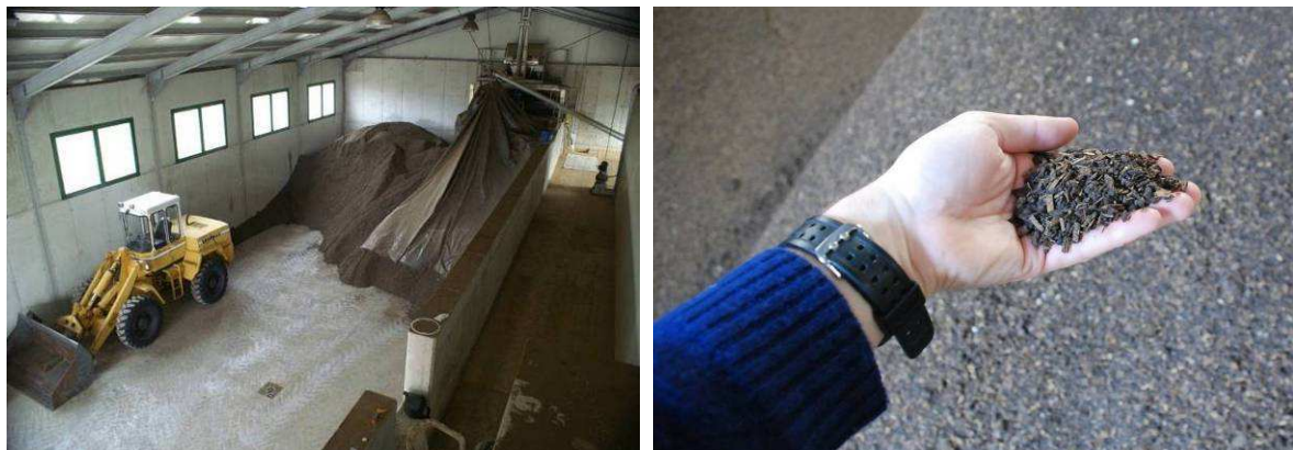
Figura 115: a sinistra la platea di stoccaggio del solido e a destra primo piano del prodotto (Foto A. Chiumenti).
