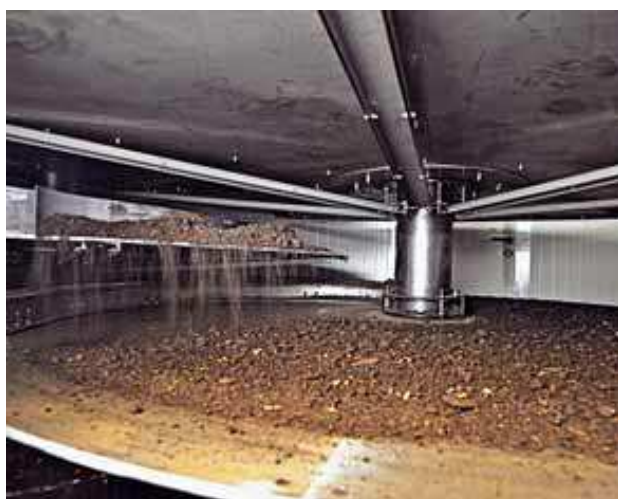
Figura 133: il sistema di essiccazione a dischi sovrapposti comprende la camera di essiccazione a dischi rotanti (1), gli scambiatori di calore acqua-aria nell'ordine da recupero dall'aria in uscita (2, 3, 4), dal motore, dai fumi (6), lo scarico (5), il ventilatore estrattore (7) e il camino (8). Foto Chiumenti; schema Dalpitech
