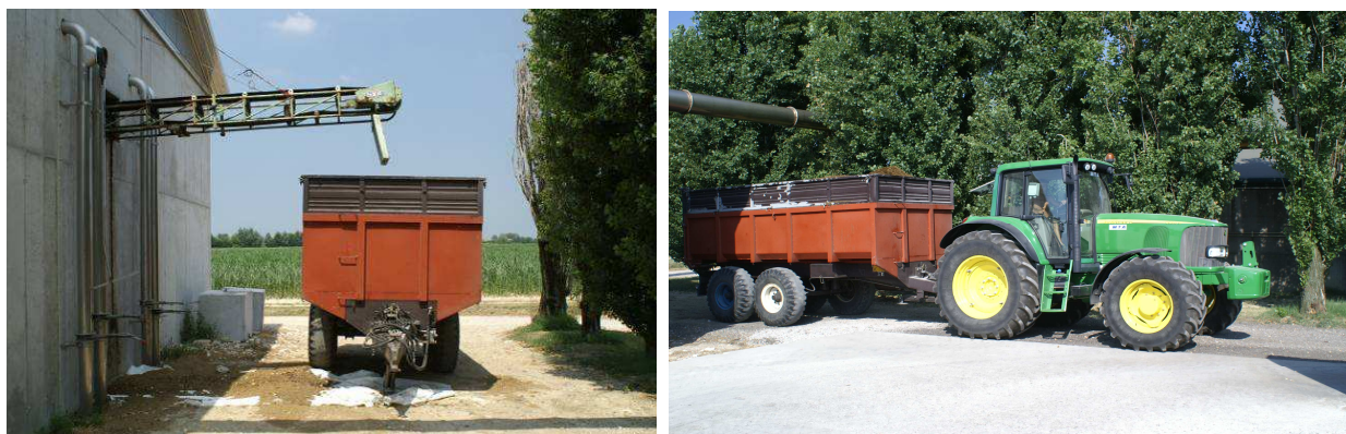
Figura 38: il carro rimorchio utilizzato per raccogliere la frazione solida prodotta dal separatore l/s.
