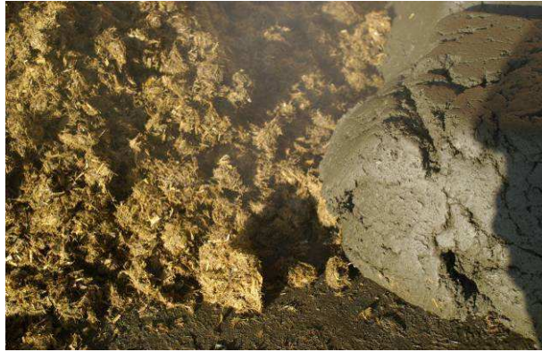
Figura 25: particolare degli output solidi dell'impianto: separato solido ottenuto dal separatore S/L a compressione elicoidale (a sinistra) e frazione solida separata da centrifuga (a destra) .
