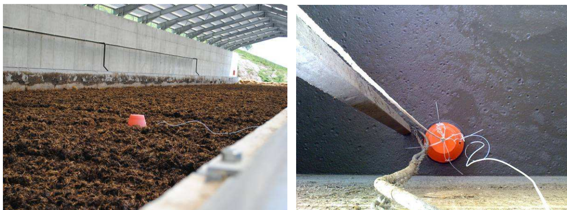
Figura 87: primo piano della “camera statica” utilizzata sia sulla superficie del prodotto che sul pelo libero dello stoccaggio.
