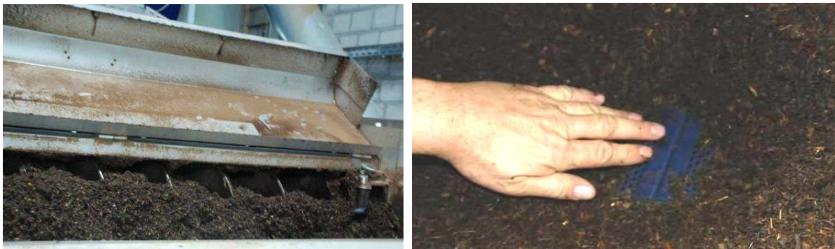
Figura 114: a sinistra primo piano della coclea che distribuisce uniformemente il solido sul nastro di essiccazione (a destra) (Foto A. Chiumenti).
