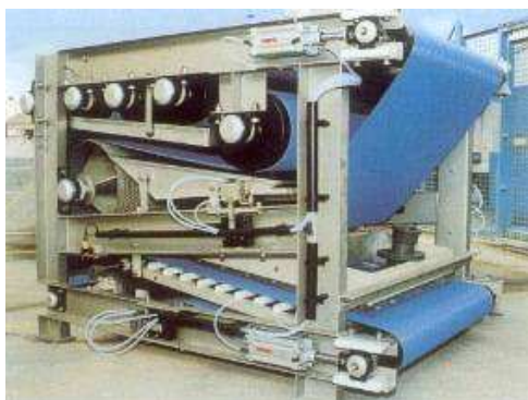
Figura 15: esempio di nastro pressa e relativo schema funzionale (fonte: Moreschini).
