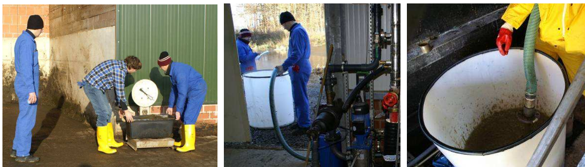
Figura 60: determinazione dei flussi di massa utilizzando metodi gravimetrici e volumetrici.
