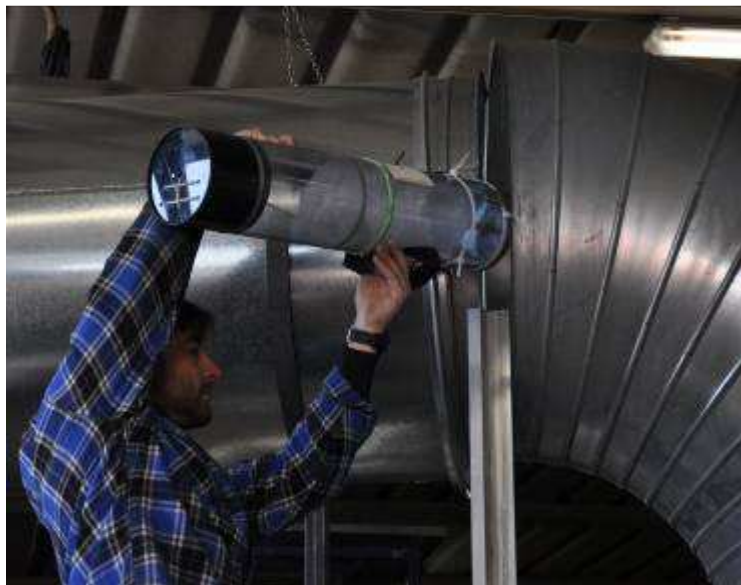
Figura 135: fase di campionamento dell'aria esausta.
