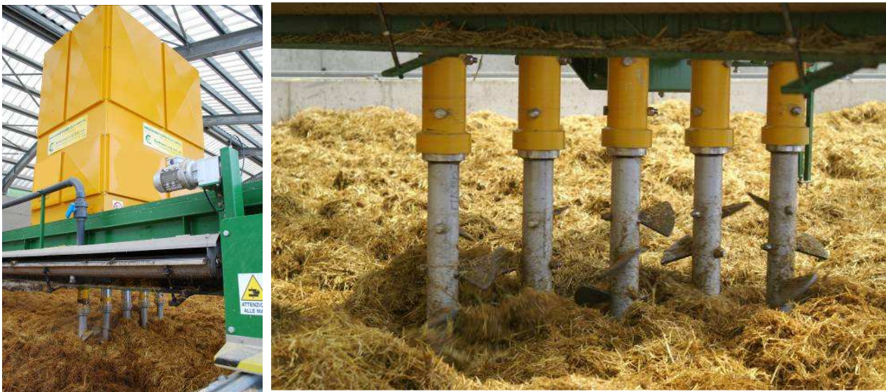
Figura 82: l'unità di dislocamento (a sinistra) e l'apparato di rivoltamento e delle coclee aventi la duplice funzione di movimentare il prodotto e di aerazione (a destra) (Foto A. Chiumenti).
