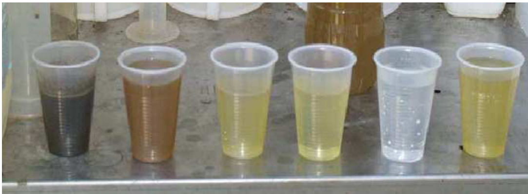
Figura 66: nell'ordine da sinistra: chiarificato dalla centrifuga, dalla flottazione, permeato e concentrato dall'ultrafiltrazione, permeato e concentrato dall'osmosi (Foto: Chiumenti).
