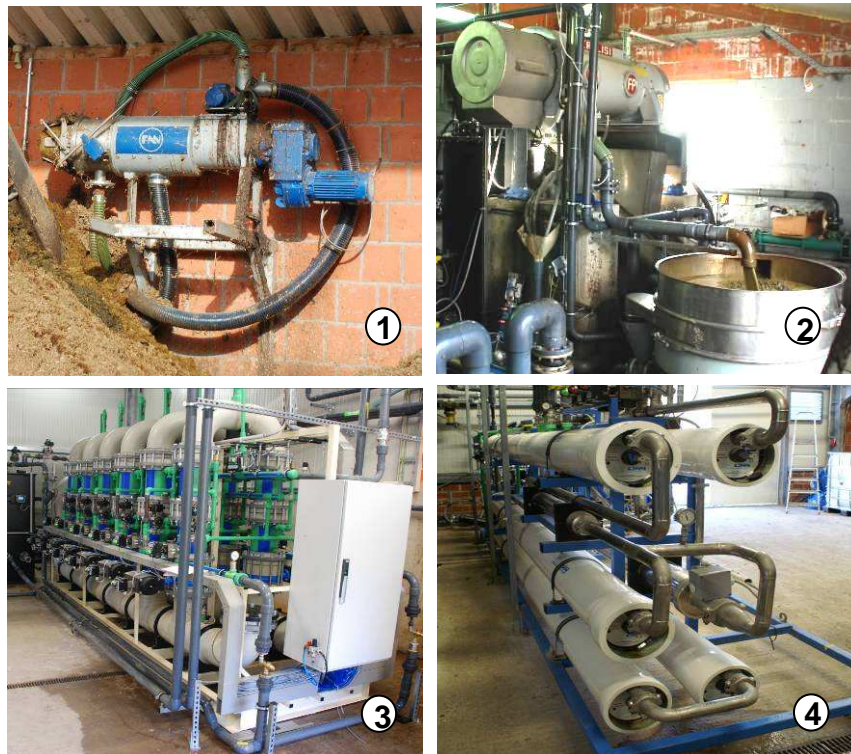
Figura 53: i quattro principali stadi di trattamento: 1 - separazione liquido/solido con separatore a compressione elicoidale, 2 - separazione con centrifuga decanter, 3 - ultrafiltrazione, 4 - osmosi inversa.
