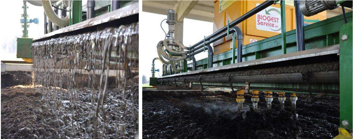
Figura 77: fasi di distribuzione del digestato e di rivoltamento: il vapore sta ad indicare una fase di fermentazione termofila.
