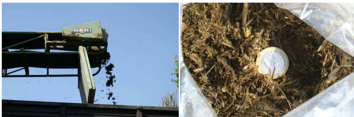
Figura 39: particolare del nastro trasportatore che convoglia all'esterno il separato solido, e particolare di quest'ultimo.
