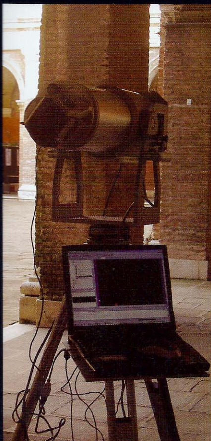
Il rilievo delle volte del portico con il Laser Scanner 3D
