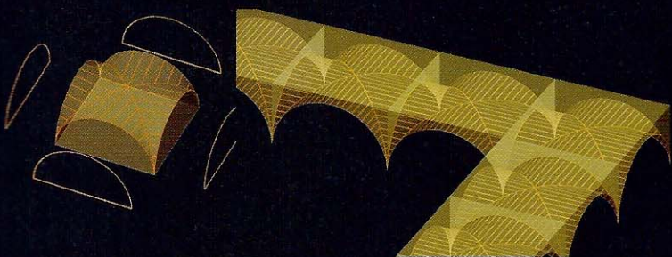
Individuazione delle generatrici e direttrici geometriche e costruzione del modello solido tridimensionale
