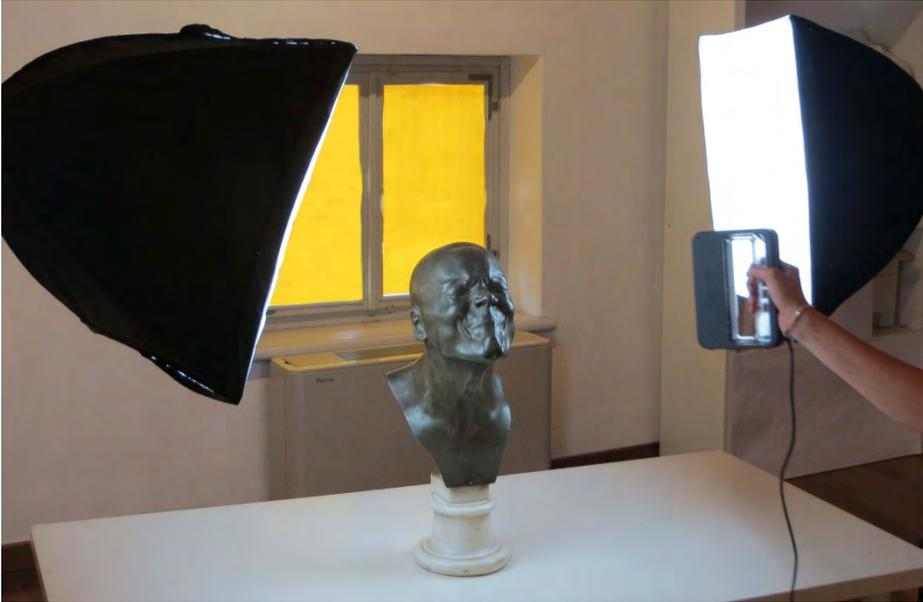
Fig. 6 – Fase di scansione 3D a interpolazione di microfotografie.
