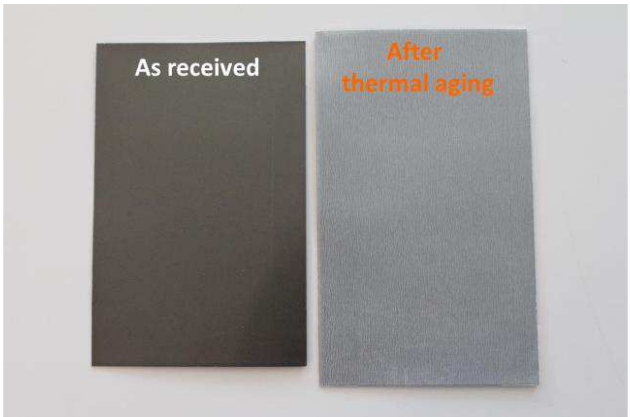
Figura 5.19 Stato di un campione dopo il processo di invecchiamento termico.
