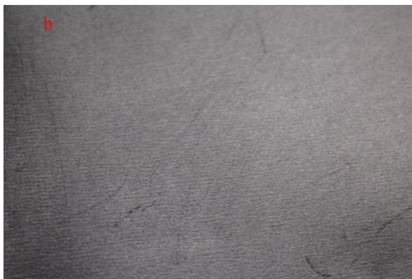
Figura 5.29 Superficie delle piastre dopo la prova di cottura con cibo: a) campione invecchiato per due settimane, b) campione non invecchiato.
