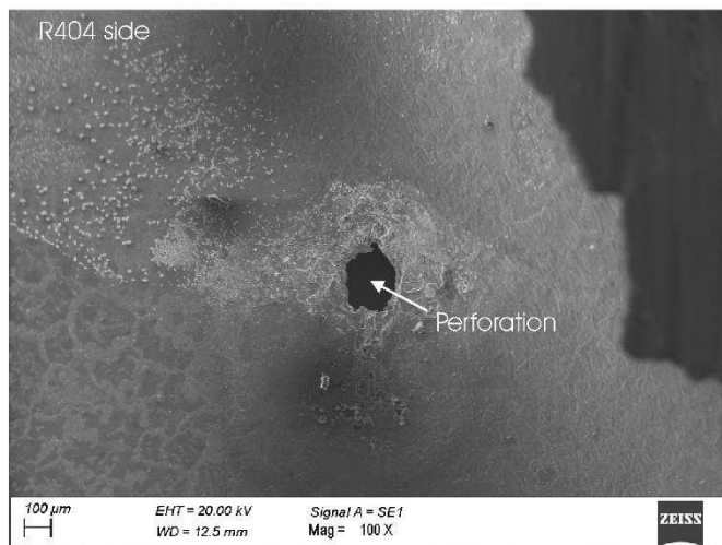
Figura 4.4 A) Immagine SEM della zona perforata nel lato a contatto con acqua; B) ed in contatto con il fluido refrigerante.
