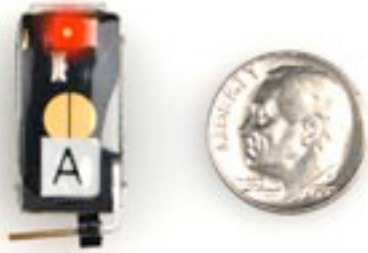
Figure 1. LED attivo. Dimensioni 20 x 14 x 3.2 mm
